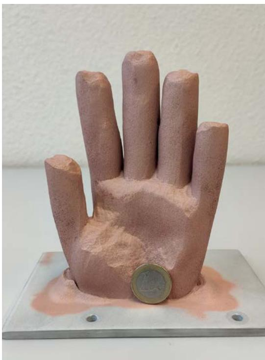
thermique, Sihao Deng a fait monter d'un cran les capacités du *Cold Spray* avec la fabrication de cette main en cuivre, symbole parfait d'un objet complexe en 3D que la technologie peut
